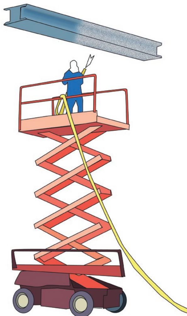
Aplicación de Fibrexpán sobre una estructura de acero. Proyección con ayuda de carretilla elevadora.
